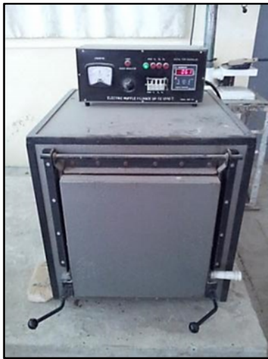
الشكل (6): الفرن الكهربائي المستخدم لإكمال عملية البلمرة.
