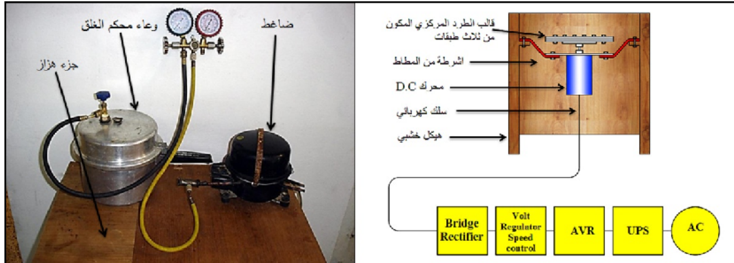
الشكل(3): المخطط العام لمنظومة السباكة بالطرد المركزي
