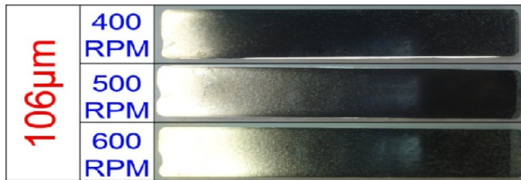
الشكل (7): نماذج المواد المتراكبة المتدرجة وظيفياً المصنعة بسرع دورانية مختلفة.
